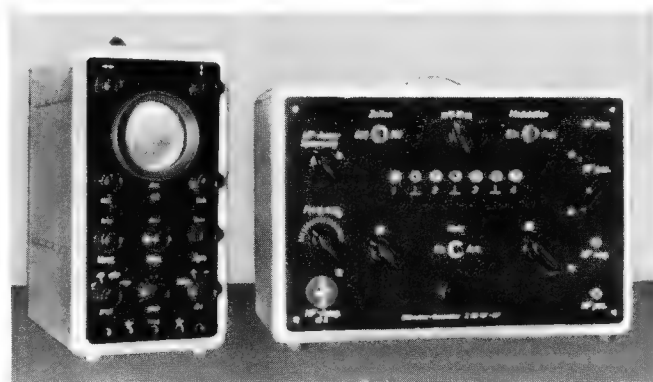
Zwei Meßgeräte, bei denen die Frontplatten nach dem hier beschriebenen Verfahren hergestellt wurden; links der Service-Oszillograf TO 358, gebaut nach FUNKSCHAU 1959, Heft 2, rechts der Bildmuster-Generator nach FUNKSCHAU 1955, Heft 20
